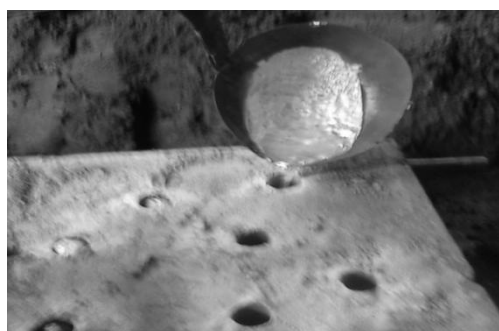
Fig: 2 Pouring the molten metal in die cavity
