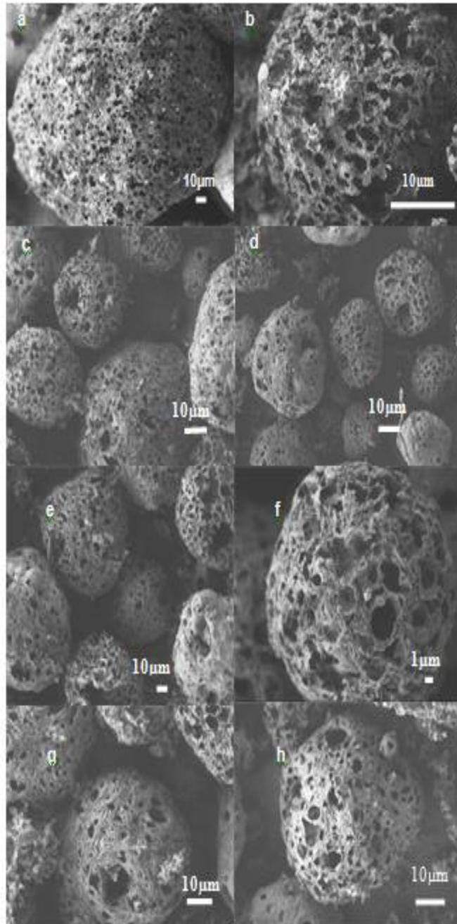
**Figure 2.** Particles of sieved particle size fractions (SPSF): a)  $>177\mu\text{m}$ , b)  $149-177\mu\text{m}$ , c)  $125-149\mu\text{m}$ , d)  $105-125\mu\text{m}$ , e)  $88-105\mu\text{m}$ , f)  $63-88\mu\text{m}$  and g)  $>63\mu\text{m}$  and h) crude carbon rich-fly ash (CRFA).
