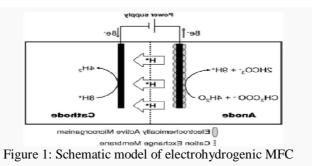
Anode:  $CH_3COO^++4H_2O\rightarrow 2HCO_3-+9H^+$ Cathode:  $8H^+ + 8e^- \rightarrow 4H_2$
