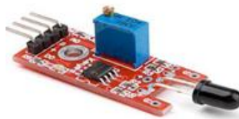
Fig.No. 6: Fire Sensor
