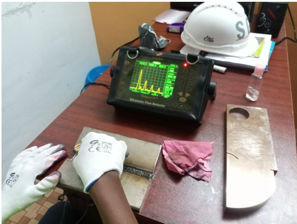
Fig: 7. Ultrasonic testing
