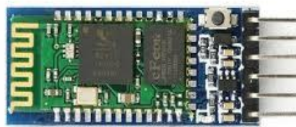
Fig.4 Bluetooth module (HC-05)
