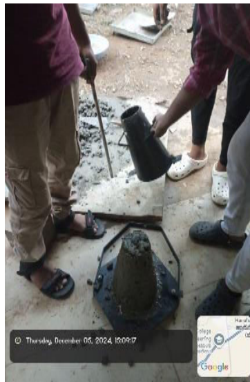
b) Slump test
